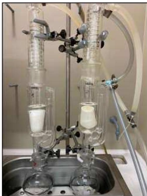
Posteriormente, se coloca el matraz en la estufa o se calienta ligeramente en el baño, para retirar los restos de éter, se deja enfriar y se pesa. La diferencia de la masa inicial del matraz y la final, será el contenido en grasa de la muestra
